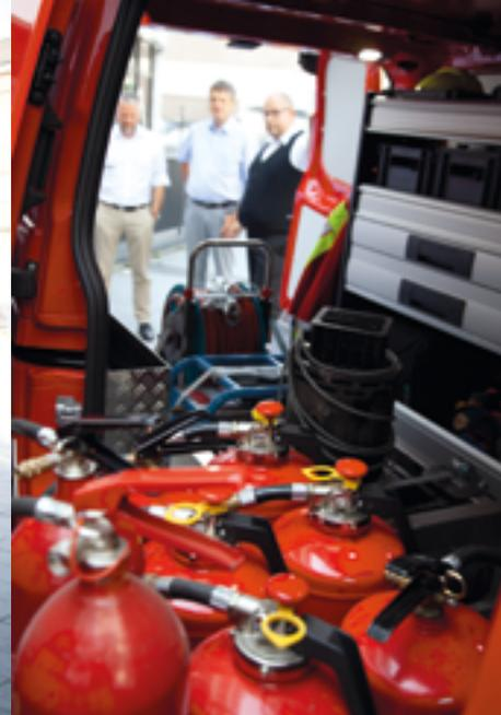
Der Transporter ist voll ausgestattet – inkl. des einsatzbereiten Wandhydranten, der Gasflaschen und der unterschiedlichen Feuerlöscher.
