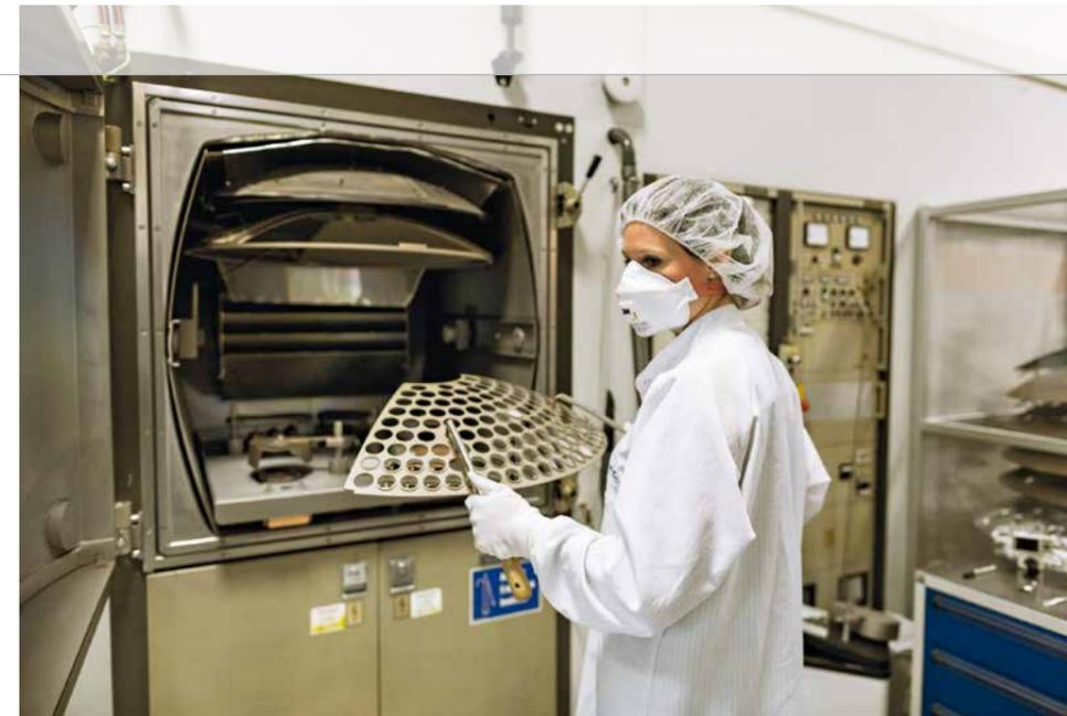
Einlegen einer Kalotte in die Beschichtungsanlage
