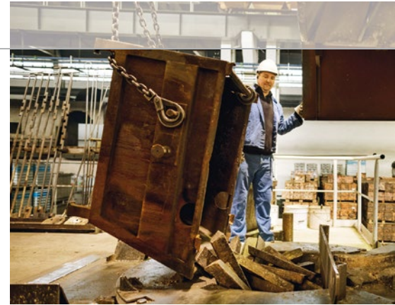
Induktionsofen: Besetzen des Ofens mit Vormaterial
