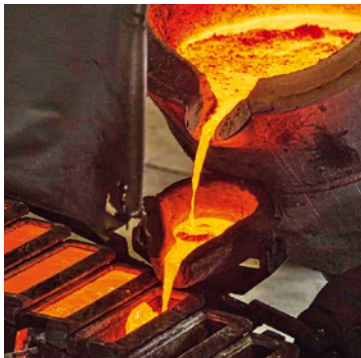
Abgießen der Schmelze in den Trichter
