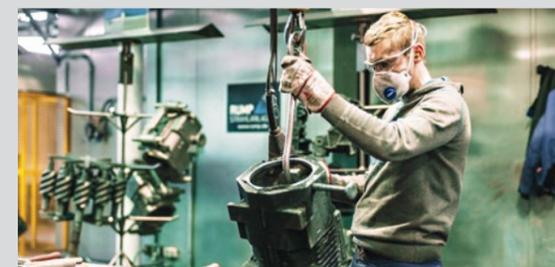
Ein Gussteil hat bis zu 12 Kerne, die in der Kernmontage zusammengesetzt werden (2. Reihe von unten, li. und Mitte). Mit Hightech wird an der CNC-Fräsmaschine gearbeitet (oben re.). In der Strahlanlage werden die Gussteile bearbeitet (2. Reihe v. oben, Mitte, re. und unten links).
