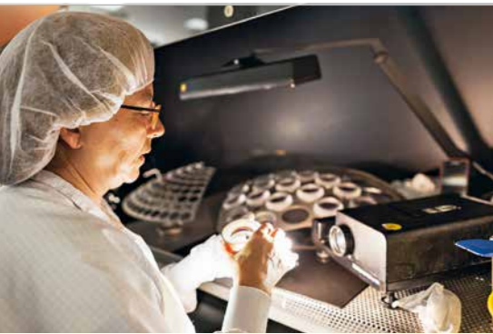
Sauberkeitskontrolle nach dem Beschichten.
