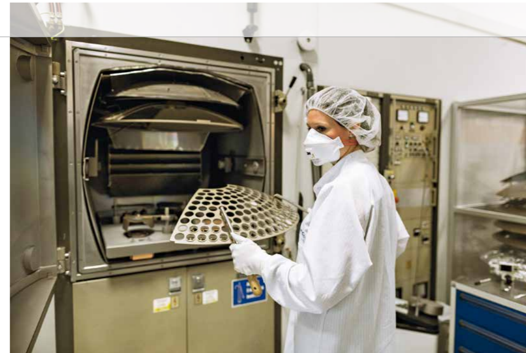
Einlegen einer Kalotte in die Beschichtungsanlage
