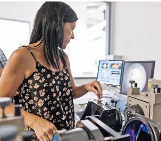
Geometriemessung am Interferometer
